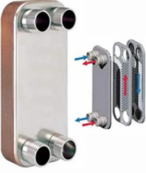
Contalı plakalı eşanjörlere göre farklı olan lehimli eşanjörler sızdırmazlığın önemli olduğu yerlerde kullanılmaktadır. Yüksek sıcaklıkta, vakum altında ,bakır veya nikel malzemeleri kullanılarak sızdırmazlık sağlanan ekipmanlardır
