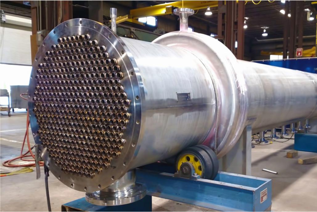
Borulu eşanjör tasarımı yapmak için gerekli olan bilgiler; akışkanların debisi, sıcaklıkları ve fiziksel özellikleridir. Bunun yanında uygulamaya bağlı olarak önemli olabilecek diğer veriler, giriş basıncı, maksimum kabul edilebilir basınç düşüşü ve akış hızıdır.
